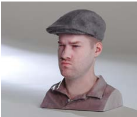
Model po dokončení tisku nutné “vydolovat” z bloku papíru. Tiskárna automaticky nařezává okolní materiál na kostičky, takže proces není tak složitý.
